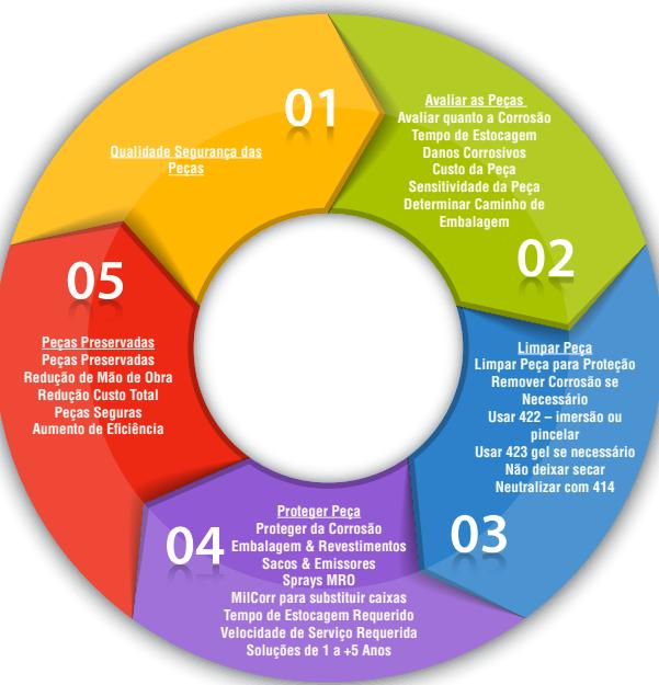
O Ciclo de Limpeza, Proteção e Preservação Cortec® para Indústrias de Mineração e Off-Road começa com a qualidade e segurança de verificação de peças. Para alcançar os mais altos padrões de proteção corrosiva, essas peças e seu desempenho são analisados, e a questão de qualidade é resolvida através da Cortec® em cada etapa. Verificações repetidas são feitas e os testes são aplicados para garantir que cada produto atenda as normas mais rigorosas sobre a qualidade.
