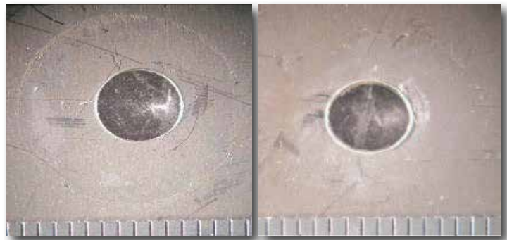
Exemplos de corrosão de fendas para exposição atmosférica de aço inoxidável revestido com CPC (controle esquerdo e direito - EcoLine 3690 da Cortec)
