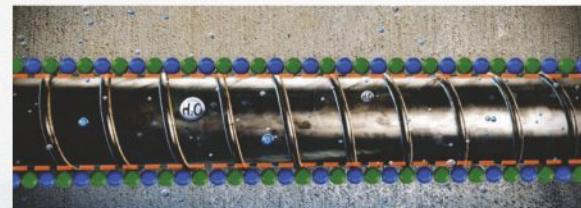
3 Quando o MCI chega perto da armadura, ele tem atração iônica a ela, e forma seu filme protetivo monomolecular. A afinidade do MCI com o metal é maior do que a água, cloretos, oxigênio e outros contaminantes corrosivos.
