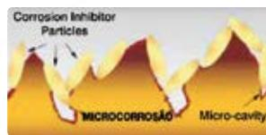
Os revestimentos tradicionais não podem proteger as microcavidades, devido ao tamanho relativamente grande das partículas dos inibidores de corrosão, tais como nitrato, alumínio e zinco. A micro corrosão começa nessas cavidades, quando se utiliza revestimentos tradicionais.
