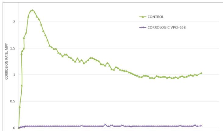
Leituras de corrosão de sondas de resistência elétrica (ER) ao longo de 4000 horas de teste.
