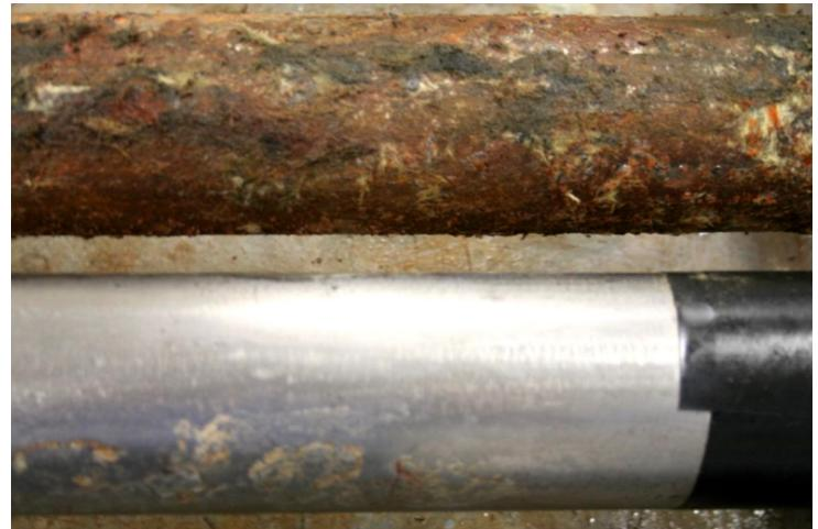
Superfícies de tubos após 210 dias de teste de corrosão. O Inibidor CUI CorroLogic® foi aplicado no tubo inferior.
