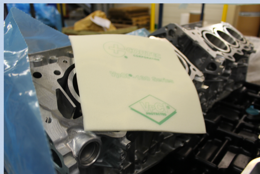
VpCI®-130 Series: proteção de motores
