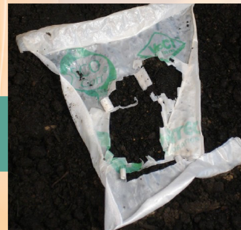
ECO-Corr Film: saco biodegradável já em processo de degradação
