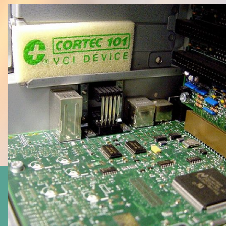
VpCI®-101: proteção de placas e circuitos elétricos
