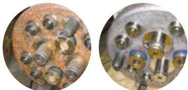
VpCI®-422 - removedor de corrosão orgânico, remove efetivamente corrosão e manchas de aço, ferro, cobre, latão e cromo.
